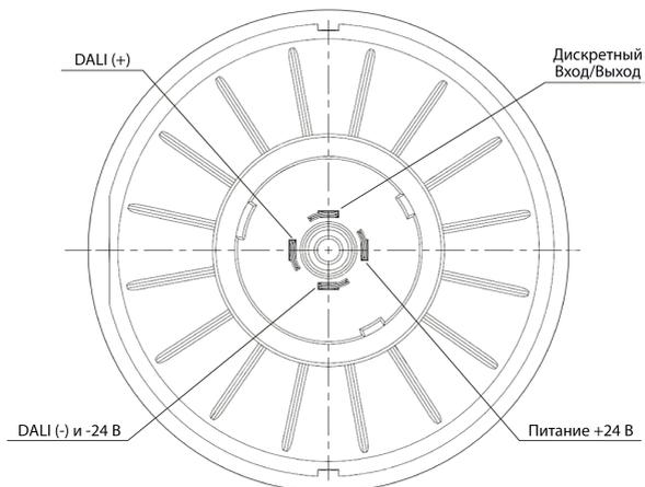
Рисунок 5 - Распиновка разъёма
